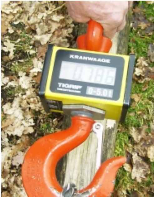
Abbildung Nr. 6 a): Zur Ermittlung der Zugkräfte wurde ein gewerblicher Kraftmesser benutzt, der die Bestimmung der Kräfte bis zu 50000 N erlaubt.
