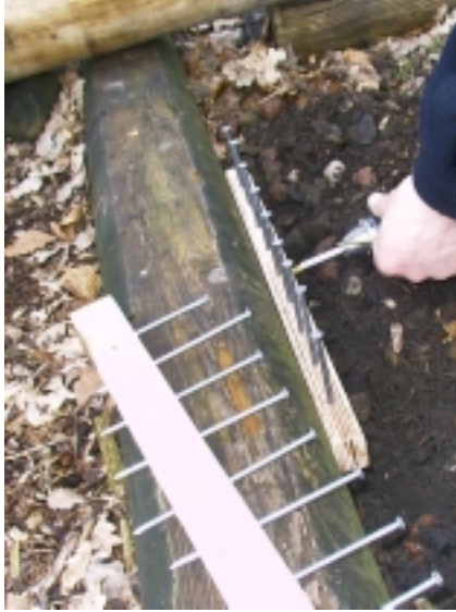
Abbildung Nr. 7 a) Aufbau einer Leiste zur Messung der Quetschungen im Schienenholz
