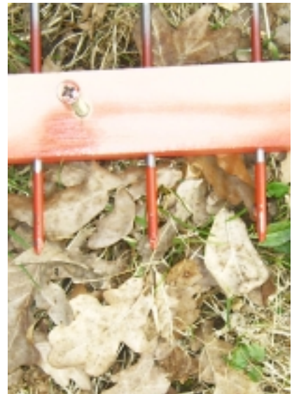
Abbildung Nr. 7 d) Die Verschiebung der Nägel ist ein Maß für die Quetschungen der Schienen.
