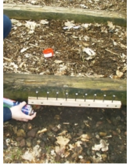
Abbildung Nr. 7 b) Markieren der Lage der Nägel mit einem Sprühlack.
